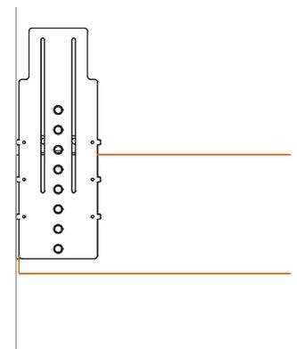
Dima per la foratura precisa sulla muratura. Nel kit vengono fornite tutte le misure necessarie per l'utilizzo delle staffe STEEL - CL
