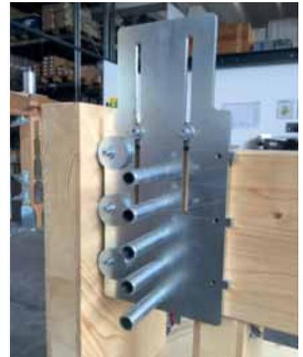
Il nuovo sistema che permette il centraggio perfetto e rapido dei fori delle piastre a scomparsa STEEL - CL, da utilizzare con il trave in opera, evitando quindi il disallineamento dei fori realizzati su trave a terra come da metodo tradizionale.
