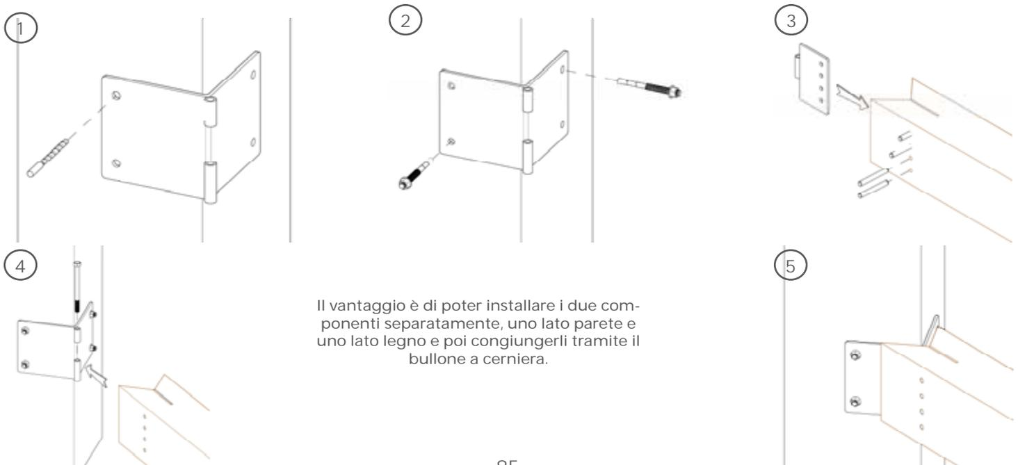
Il vantaggio è di poter installare i due componenti separatamente, uno lato parete e uno lato legno e poi congiungerli tramite il bullone a cerniera.
