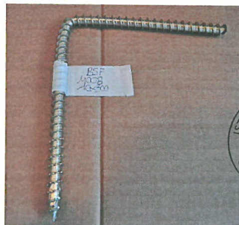
Fotografia 7. Vite BSF diametro 10mm, durante il test (a sinistra) e vite BSF diametro 10mm, dopo il test (la vite presenta un angolo di piegatura maggiore di quello imposto durante il test a causa della necessità di estrarre la vite dal setup a fine prova)
