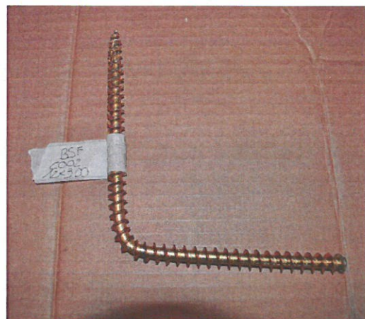
Fotografia 8. Vite BSF diametro 12mm, durante il test (a sinistra) e vite BSF diametro 12mm, dopo il test (la vite presenta un angolo di piegatura maggiore di quello imposto durante il test a causa della necessità di estrarre la vite dal setup a fine prova)
