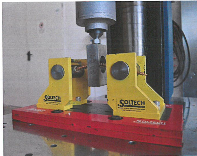
Fotografia 3. Setup di prova, vista frontale del sistema di prova per test ciclici su viti
