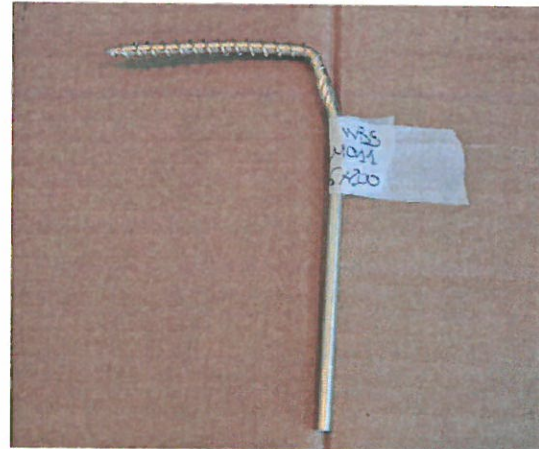
Fotografia 5. Vite WBS diametro 6mm, durante il test (a sinistra) e vite WBS diametro 6mm, dopo il test (la vite presenta un angolo di piegatura maggiore di quello imposto durante il test a causa della necessità di estrarre la vite dal setup a fine prova)
