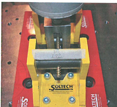
Fotografia 7. Vite BSF diametro 10mm, durante il test (a sinistra) e vite BSF diametro 10mm, dopo il test (la vite presenta un angolo di piegatura maggiore di quello imposto durante il test a causa della necessità di estrarre la vite dal setup a fine prova)
