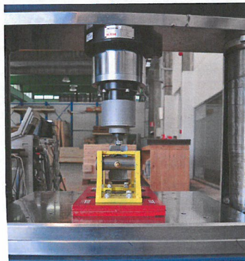
Fotografia 4. Setup di prova, vista laterale del sistema di prova per test ciclici su viti
