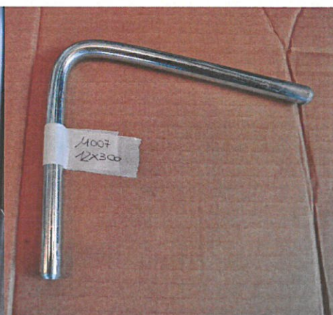
Fotografia 9. Spinotto diametro 12mm, durante il test (a sinistra) e spinotti diametro 12mm, dopo il test (la vite presenta un angolo di piegatura maggiore di quello imposto durante il test a causa della necessità di estrarre la vite dal setup a fine prova)
