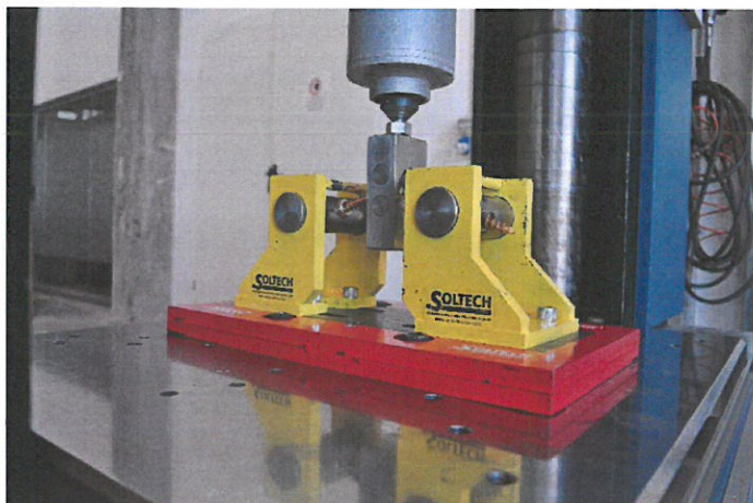
Fotografia 8. Vite BSF diametro 12mm, durante il test (a sinistra) e vite BSF diametro 12mm, dopo il test (la vite presenta un angolo di piegatura maggiore di quello imposto durante il test a causa della necessità di estrarre la vite dal setup a fine prova)
