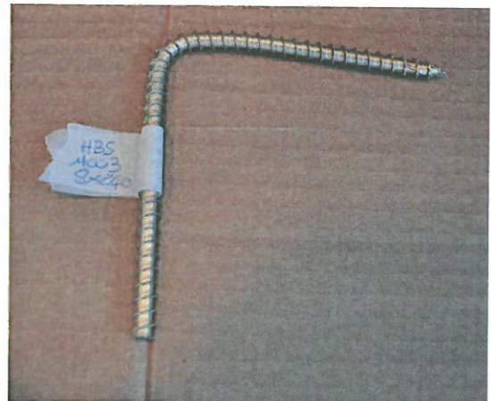
Fotografia 6. Vite BSF diametro 8mm, durante il test (a sinistra) e vite BSF diametro 8mm, dopo il test (la vite presenta un angolo di piegatura maggiore di quello imposto durante il test a causa della necessità di estrarre la vite dal setup a fine prova)
