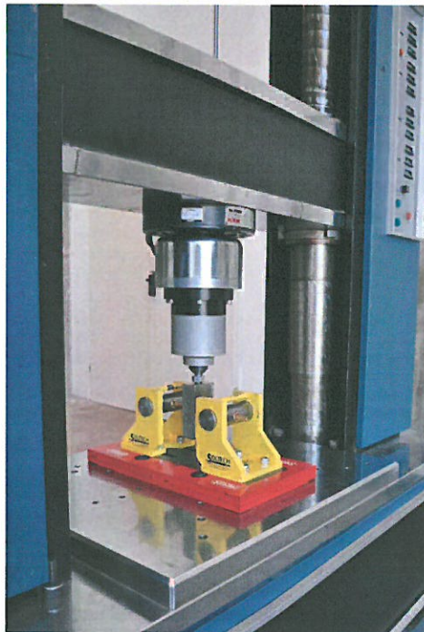
Fotografia 2. Setup di prova, dettaglio del sistema di prova per test ciclici su viti
