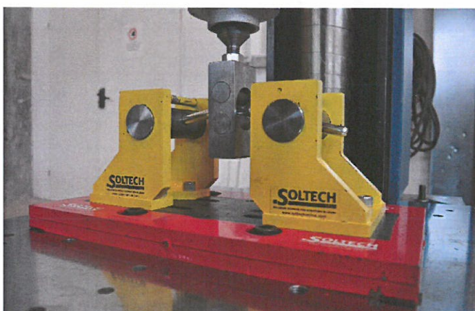
Fotografia 9. Spinotto diametro 12mm, durante il test (a sinistra) e spinotti diametro 12mm, dopo il test (la vite presenta un angolo di piegatura maggiore di quello imposto durante il test a causa della necessità di estrarre la vite dal setup a fine prova)
