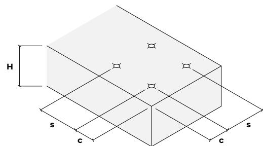
cr,N = rottura per formazione del cono di CLS
