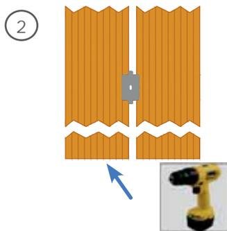
2 - una volta inserito il secondo listone si può procedere con l'inserimento della vite nel foro asolato
