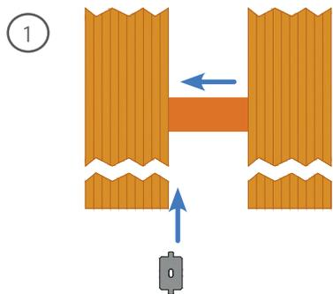
1 - Posizionare il primo listone sopra i travicelli, inserire la clip PXC nella fresata ed avvicinare il secondo listone
