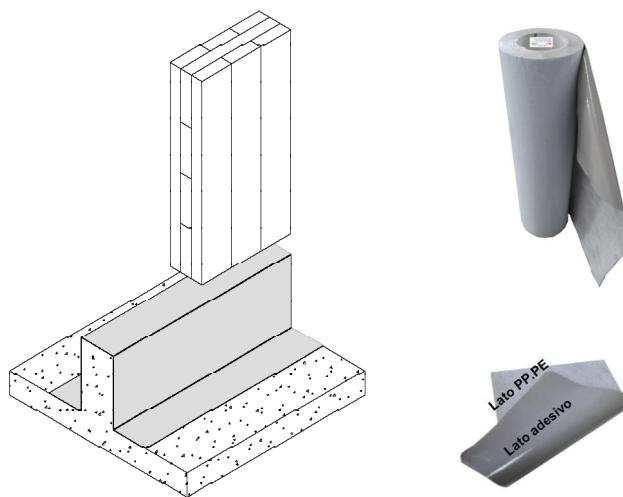
**Descrizione ST101:** membrana butilica adesiva con un film in PP.PE.
