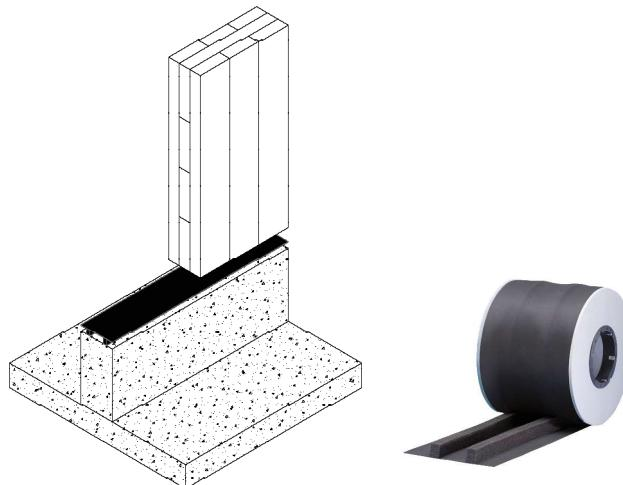
**Descrizione ST107:** è un nastro di tenuta che viene utilizzato principalmente come strato anticapillare fra le traverse d'appoggio al suolo e muro di fondazione / platea.
