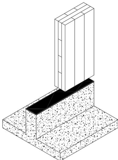
**Descrizione ST113:** neoprene in Rotoli spessore 3 mm con un'ottima resistenza all'ozono, gli agenti atmosferici ed all'invecchiamento, buona la resistenza agli oli minerali.
