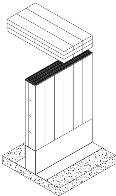
**Descrizione ST112:** guarnizione in EPDM compatto da 85mm di larghezza (divisibile in due strisce da 42,5mm) e 5 mm di spessore a superficie discontinua per garantire un ottimo abbattimento acustico dovuto all'interruzione del passaggio della vibrazione da calpestio.
