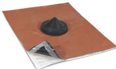
**Descrizione ST122-123:** Guarnizione in EPDM per passaggio sistemi antcaduta, tubi e pali con bande adesive in colla butilica sui quattro lati. Sistema universale per diametri da Ø25mm - Ø125mm.
