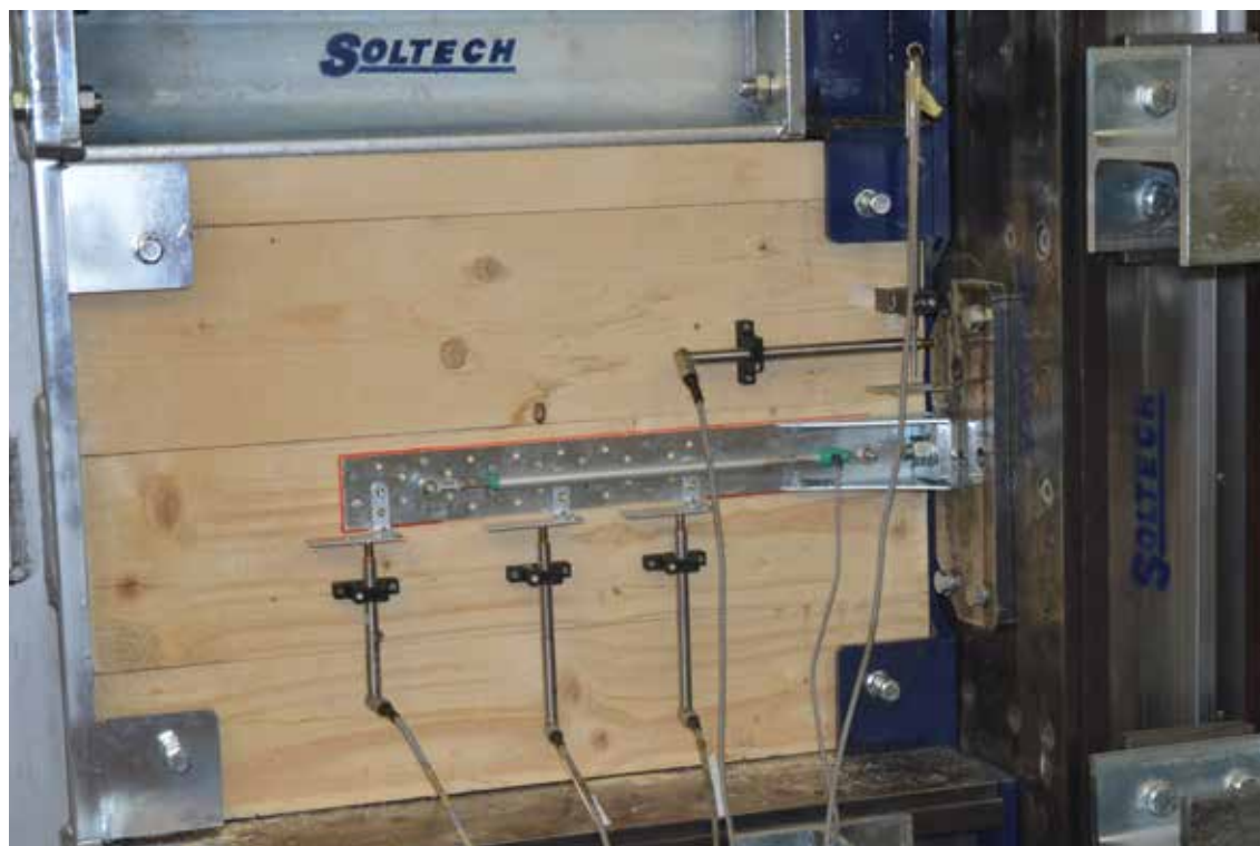
Test di laboratorio sugli Hold Down.
