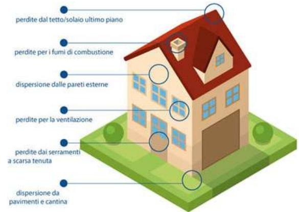
La sigillatura di punti deboli quali sovrapposizioni e raccordi di teli e guaine, chiusure tra muro perimetrale esterno e tramezzi, tetto e solai, condutture del camino, fori per gli impianti, ecc, è altresì importante ai fini del risparmio energetico e della protezione dell'edificio.
