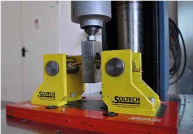
Prove di laboratorio per testare la resistenza delle viti
