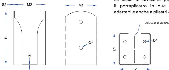
Le asole di divisione permettono di spezzare il portapilastro in due elementi, rendendolo adattabile anche a pilastri di sezione rettangolare.
