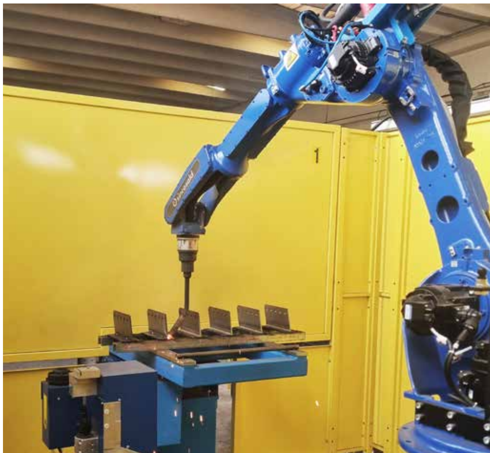
Staffe STEEL durante la fase di saldatura con robot.
