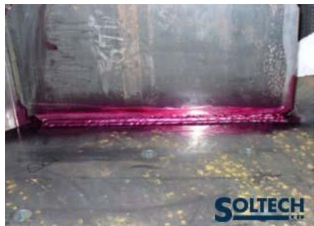
Fig. 16 & 17 – Controllo visivo-dimensionale e a liquidi penetranti sulle saldature
